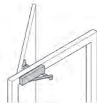
Montaje invertido, fijación del lado opuesto a la apertura
