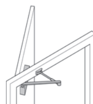
Montaje estándar fijación del lado opuesto a la apertura
